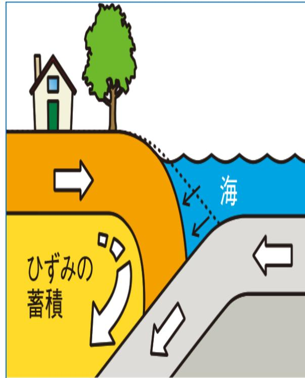
**2** ユーラシアプレートの先端部が引きずり込まれることで、ひずみが蓄積されます。
